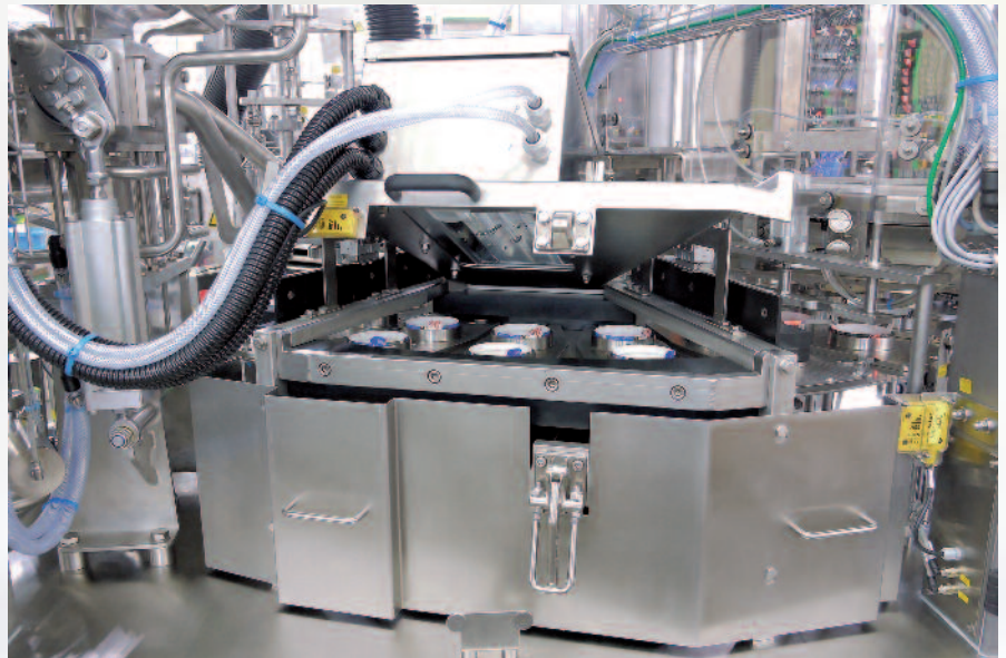
Pulsed Light System auf einem WALDNER DOSOMAT Rundläufer
