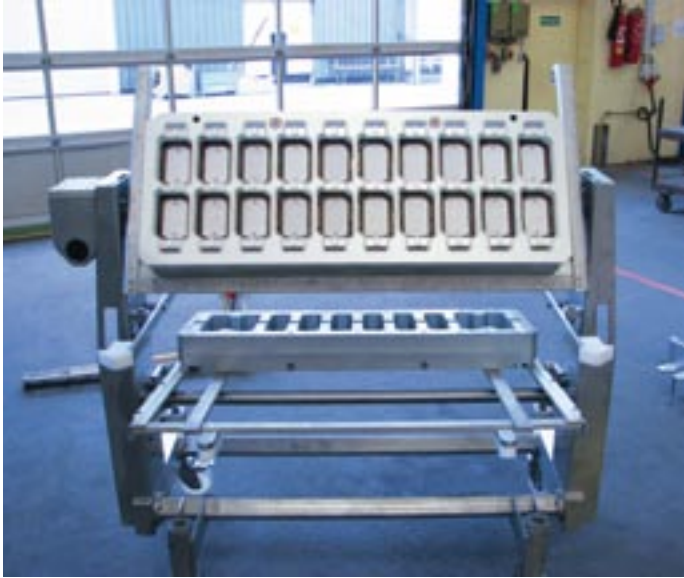
Werkzeugwagen Zur einfachen Wartung des Siegelwerkzeuges drehbar ausgeführt.
