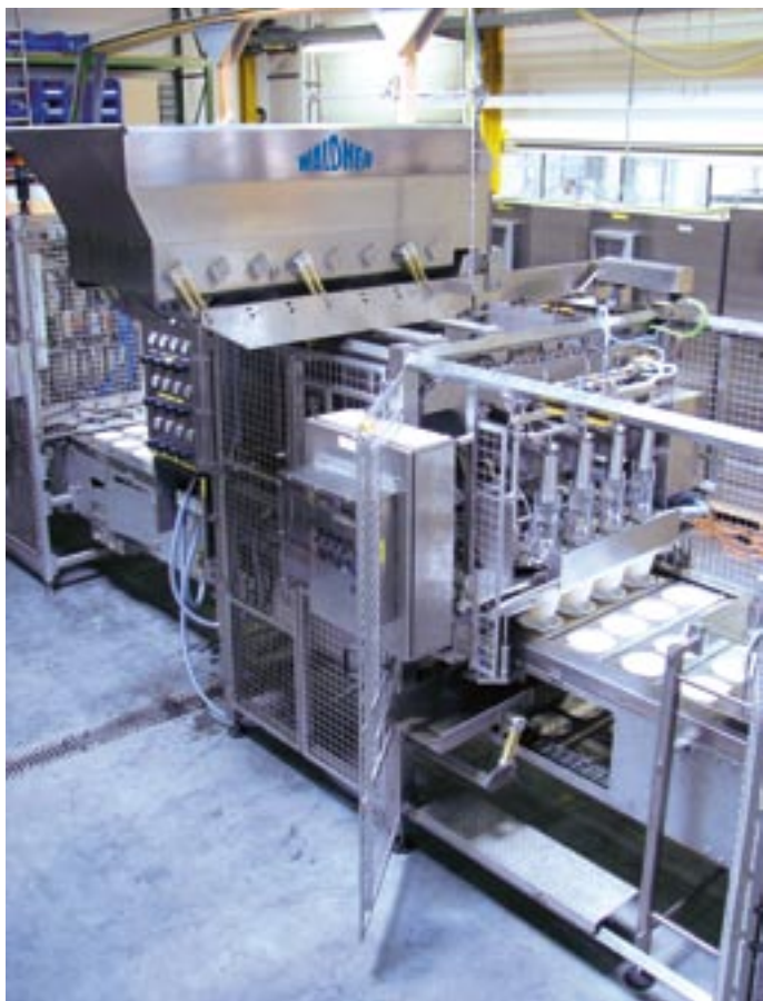
Multidos 4-fach Dosierung Zuführung über Vibrationsrinnen
