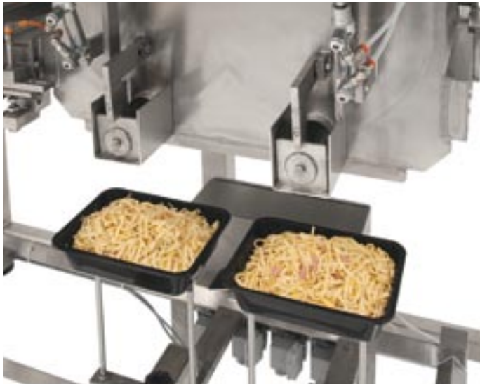
Vollautomatische Dosieranlage aufgebaut auf Wiegezellen, um auf Nettogewicht exakt zu füllen.
