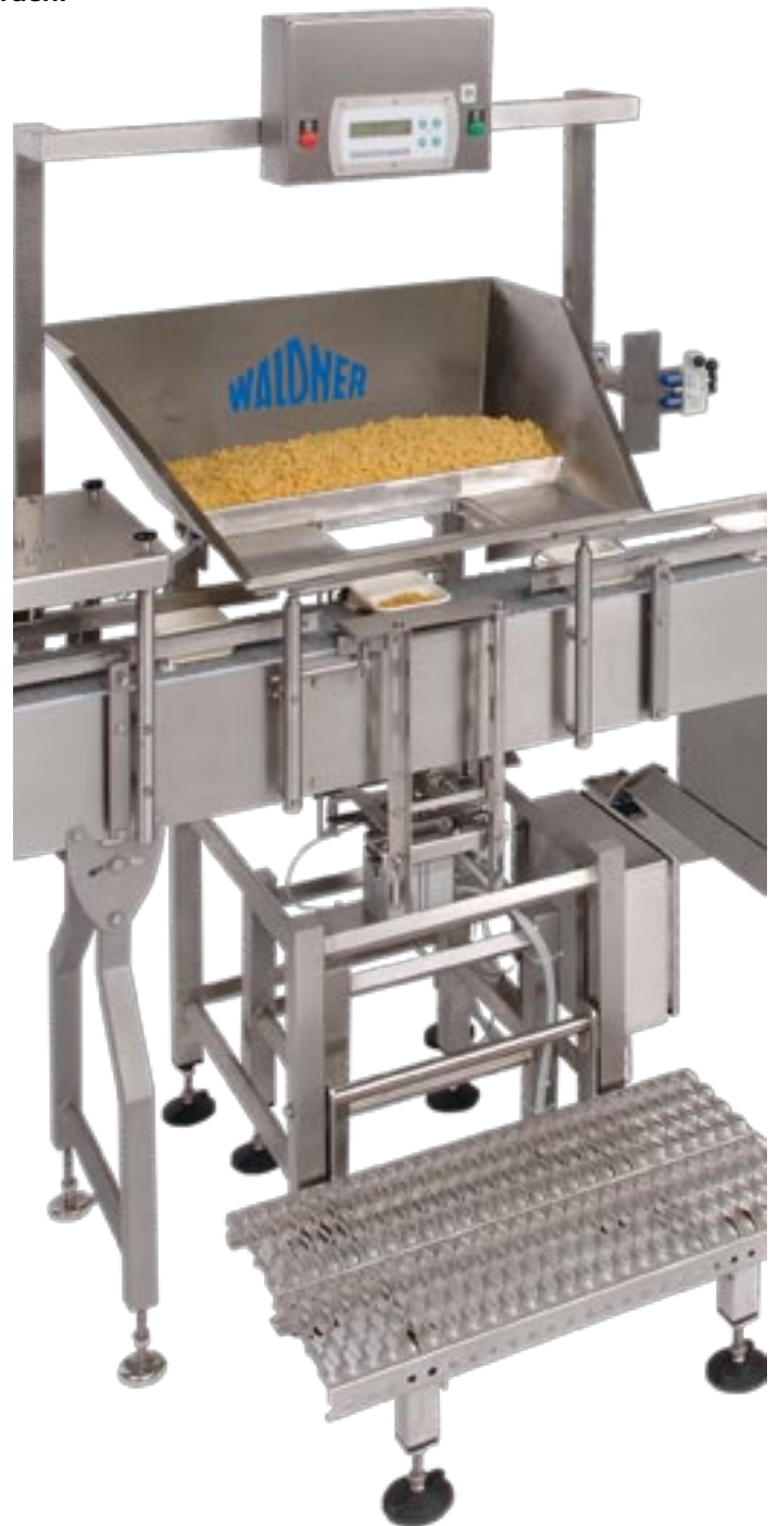
Halbautomatische Produktverwiegung Die Bedienperson füllt den Tray manuell und gibt ihn mittels Drucktasten frei zum Weitertransport. Mit visueller Gewichtsanzeige.
