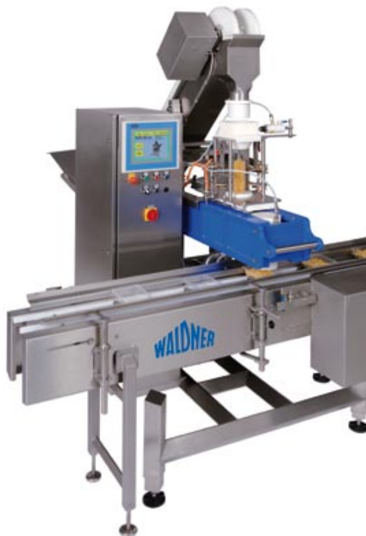
Multidos 1-fach Dosierung Zuführung über Förderband
